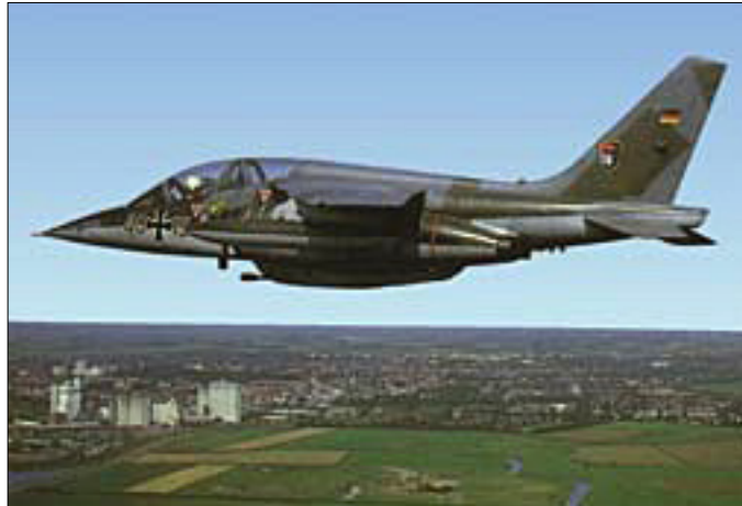
Alpha Jet. Spannweite (m) 9,11, Länge (m) 13,23, Höhe (m) 4,19, Fluggewicht (kg) 7250, Höchstgeschwindigkeit (km/h) 927, Landegeschwindigkeit (km/h) 230, Steiggeschwindigkeit (m/s) 57, Triebwerkleistung (kp) 2 x 1350, Reichweite (km) 2430, Dienstgipfelhöhe (m) 14000, Erstflug 26.10.1973
