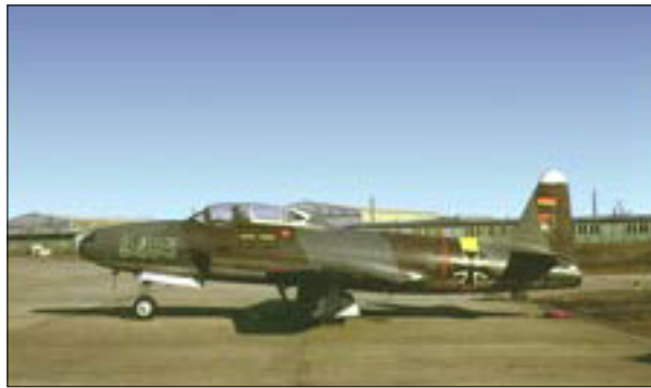
T - 33. - Spannweite (m) 11,85, Länge (m) 11,49, Höhe (m) 3,55 Fluggewicht (kg) 5432, Höchstgeschwindigkeit (km/h) 950, Landegeschwindigkeit (km/h) 220, Steiggeschwindigkeit (m/s) 25,5, Triebwerkleistung (kp) 2360, Reichweite (km) 2000, Dienstgipfelhöhe (m) 14600, Erstflug 08.01.1944.
