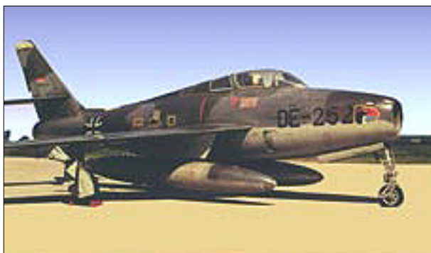
F-84F - Spannweite (m) 10,23, Länge (m) 13,21, Höhe (m) 4,57, Fluggewicht (kg) 12700, Höchstgeschwindigkeit (km/h) 1118, Landegeschwindigkeit (km/h) 260, Steiggeschwindigkeit (m/s) 41,6, Triebwerkleistung (kp) 3275, Reichweite (km) 3420, Dienstgipfelhöhe (m) 12500, Erstflug 28.02.1946.
