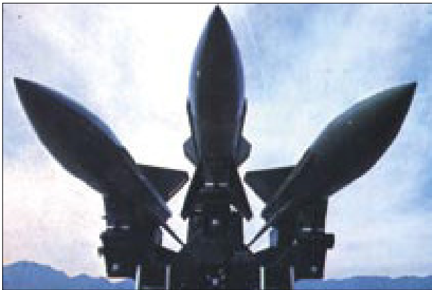
Der Lenkflugkörper IHAWK MIM-23B auf dem Startgerät AN/M-192
